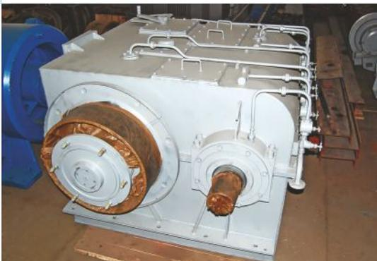
Коробка передач цепная КПЦ-700 (рисунки 1 и 2) предназначена для изменения передаваемого момента и скорости вращения валов буровой лебедки и ротора буровой установки.
